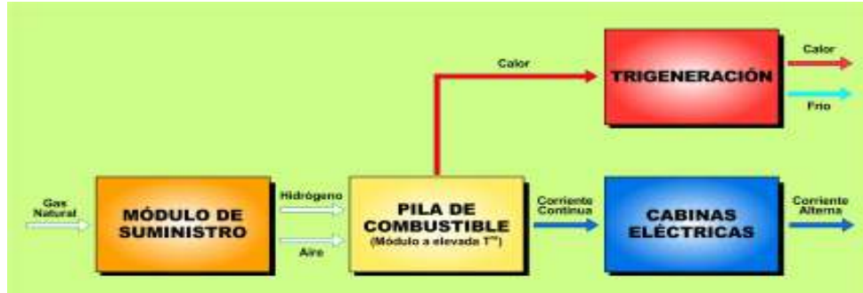
Fig. 8. Diagrama de bloques de la pila MCFC Navantia – MTU
