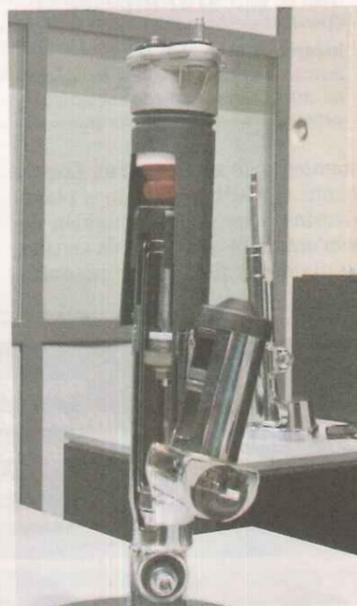
Suspensión electrónica de Tenneco.
