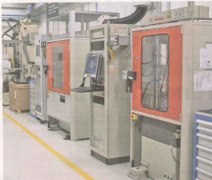
Una de las salas de Tenneco Innovación donde se ponen a prueba los amortiguadores.
