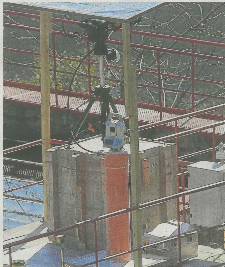
Una instalación para el control de movimientos del terreno. Foto: Efe
