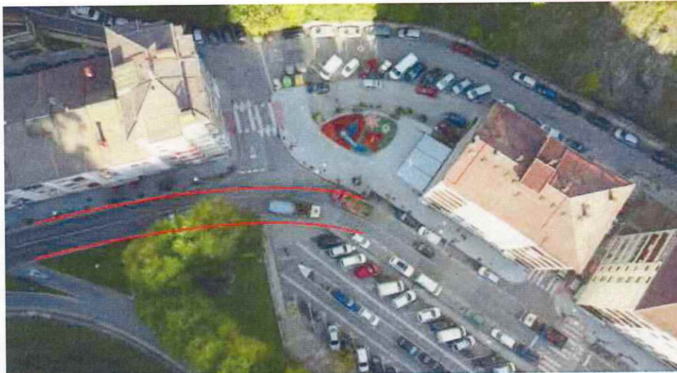
Ilustración 2: Ampliando el radio de la curva se solucionaría esta problemática
