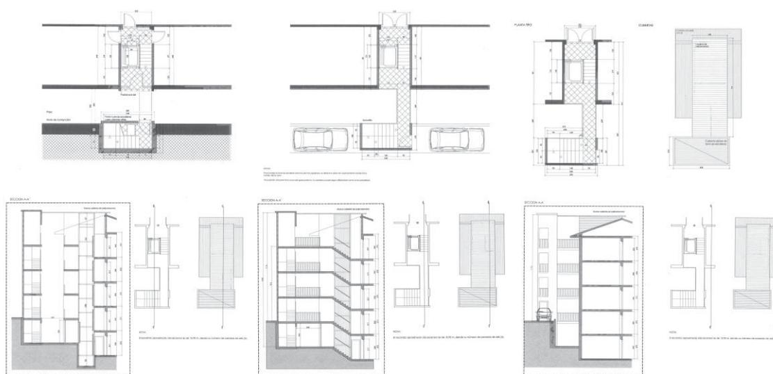
**Modelo 3. Ejecución del volumen de escaleras enfrentado al portal y fuera del mismo con una pasarela en los niveles superiores para poder acceder a los rellanos y ejecución del ascensor dentro del portal para poder acceder a las viviendas.**
