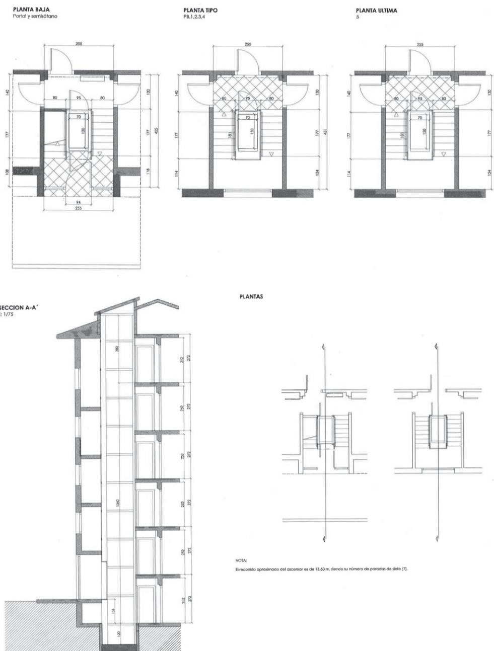
**Modelo 1. Ascensor incorporado dentro del portal existente entre los tramos de escaleras y con la modificación de las dimensiones necesarias de los mismos.**
